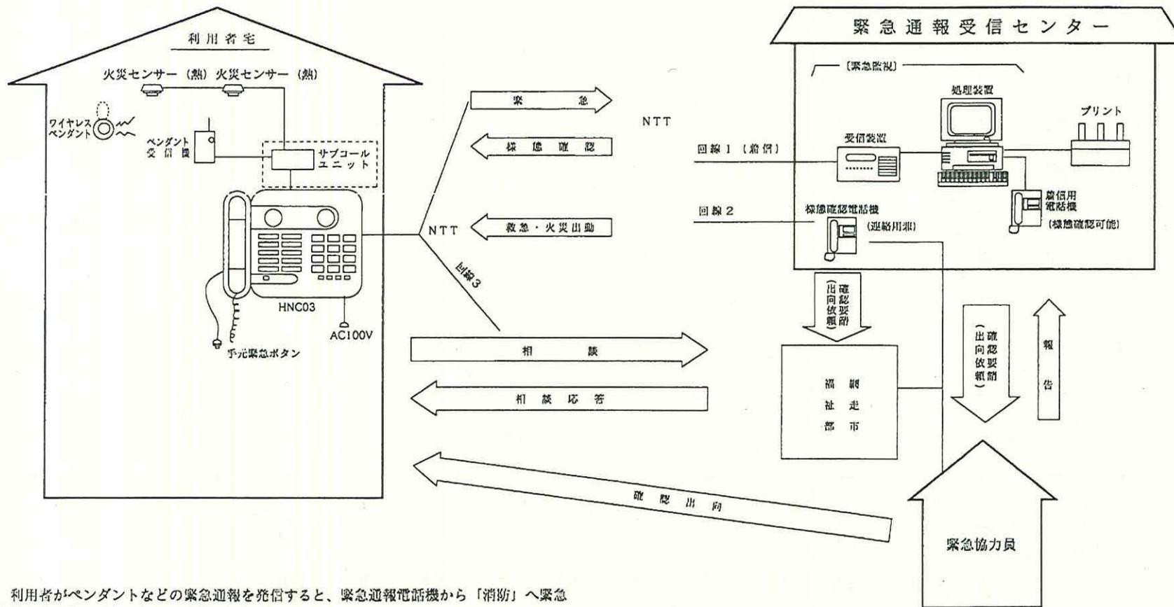
1. 利用者がペンダントなどの緊急通報を発信すると、緊急通報電話機から「消防」へ緊急事態を自動的に通報します。火災のときも同じです。
